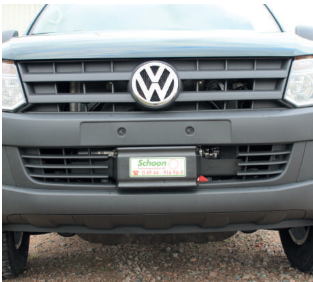
Montierte Seilwinde mit Stahlseil und Rollenseilfenster Best. Nr. 55-002932 Kunststoffseil u. Gusseilfenster Best. Nr. 55-002933
