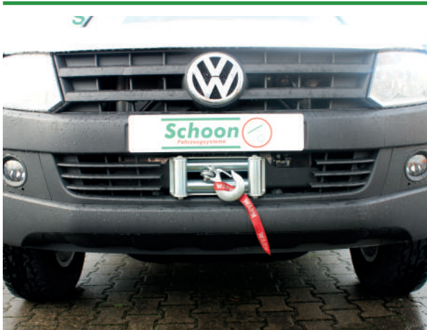
Montierte Seilwinde mit Stahlseil und Rollenseilfenster Best. Nr. 55-002932 Kunststoffseil u. Gusseilfenster Best. Nr. 55-002933
