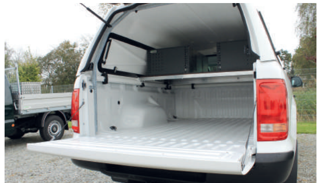
Hardtop Typ „Profi“ mit Seitenklappen Zwischenboden für Regaleinbau mit Schubläden
