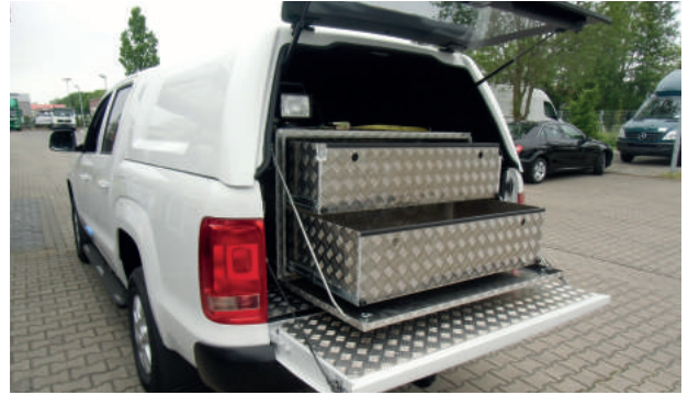
Hardtop Typ „Standard“ lackiert in Wagenfarbe Aluminium-Verkleidung und Werkzeugkiste
