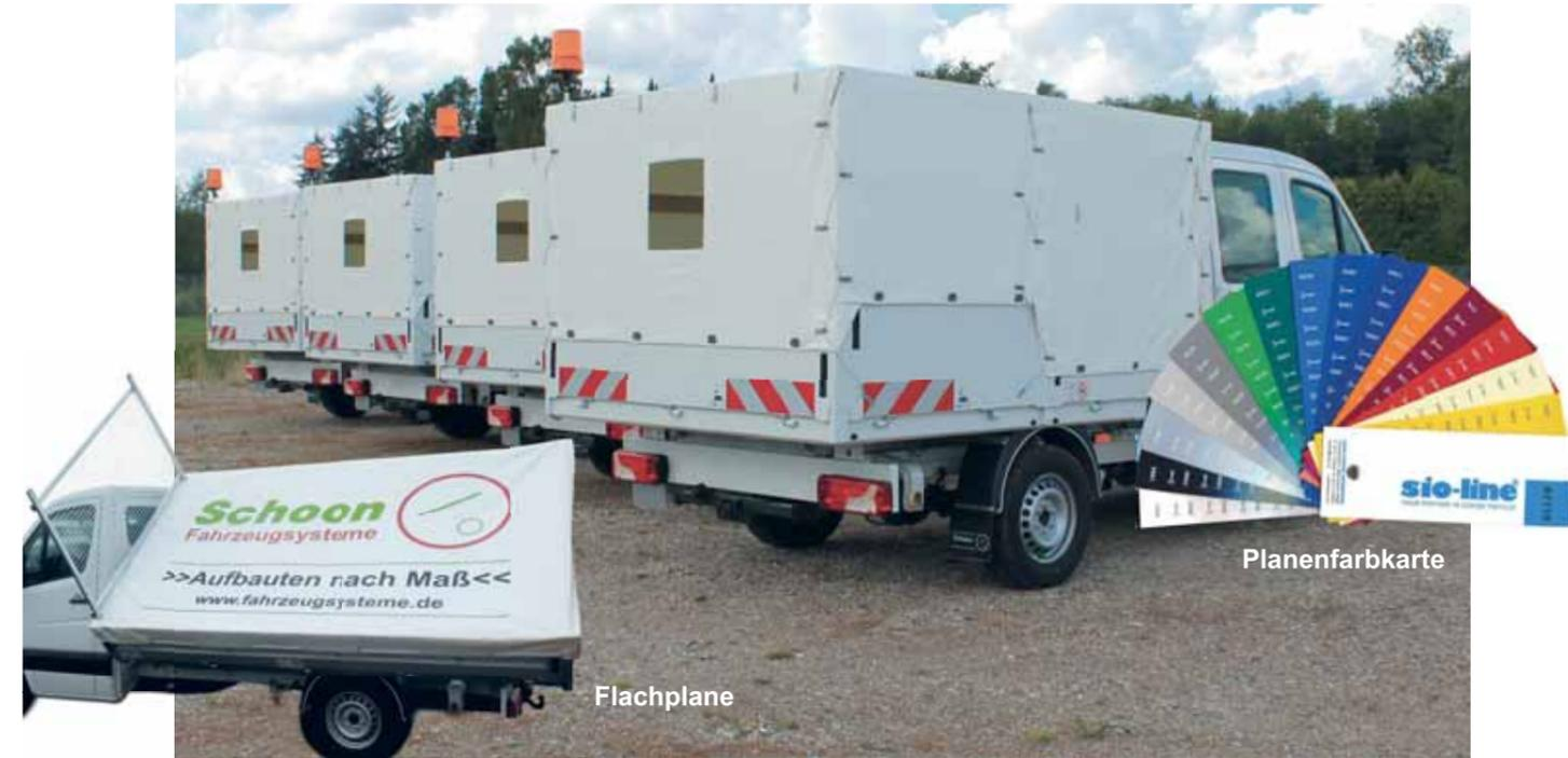
Die Grundkonstruktion des Spriegelgestells besteht aus Stahl und wird komplett im Tauchbad feuerverzinkt. Die Plane besteht aus hochwertigem LKW-Planenstoff und kann in einer Farbe nach RAL/Sioline gewählt werden. Außerdem ist die Plane mithilfe von **Drehwirbeln** „Lassowurf-Spannung“ rundum zu öffnen. Unsere Planenaufbauten sind sowohl für Schoon Pritschen und Schoon Kipper geeignet als auch für Werkspritschen. **Individuell nach Ihren Bedürfnissen!**
